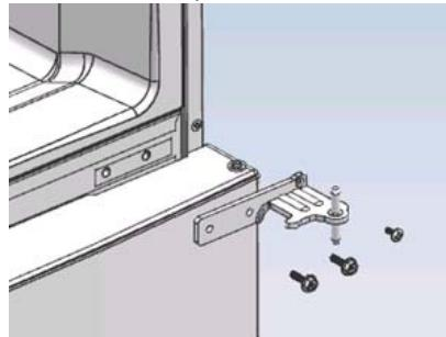
Е. Приподнимите дверь морозильной камеры на 50 мм и снимите ее.
