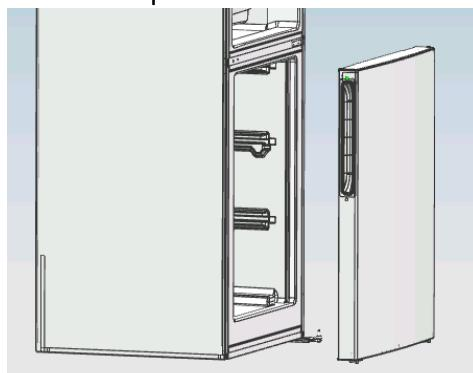
Ж. Приподнимите регулировочные опоры и выкрутите 4 болта нижней петли.
