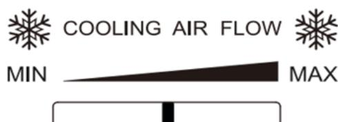
С помощью рычага можно увеличить или уменьшить подачу холодного воздуха, поступающего в отсек для хранения свежих продуктов.
