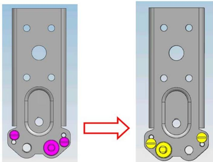
3) Установка дверей на противоположную сторону.
