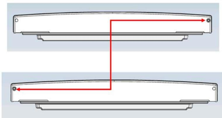
Б. Извлеките ограничители из-под нижней части двери камеры охлаждения и из двери морозильной камеры. Установите ограничители на противоположную сторону дверей.
